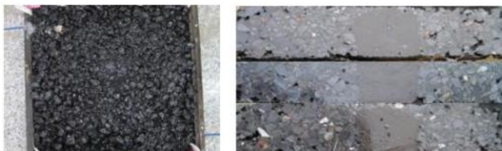
Рисунок 2 – Установка ВОД в асфальт
